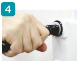
Encaixe a resistência nova, fazendo com que o fio terra (verde) passe dentro de seu interior **B** saindo pela outra extremidade **C**.
